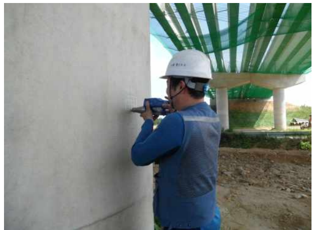
P4(상주방향) 기둥부 반발경도시험 전경
