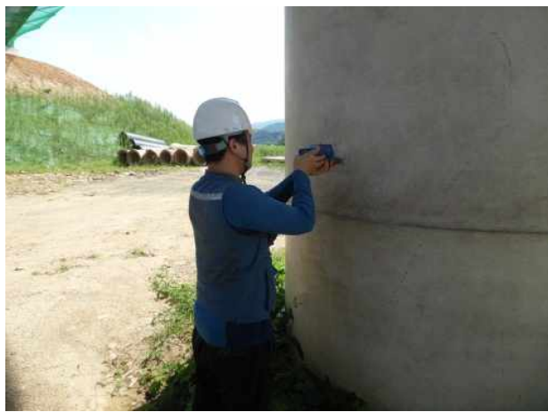
P5(영천방향) 기둥부 반발경도시험 전경
