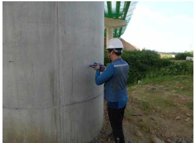
P2(상주방향) 기둥부 반발경도시험 전경
